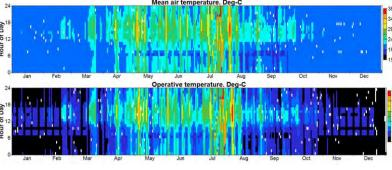
Fig. 18 INDOOR AND OPERATIVE TEMPERATURE PLOT
