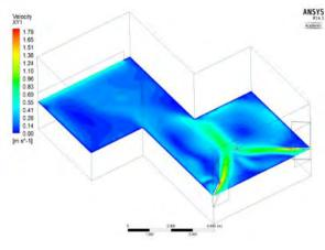
**Fig. 17** EXAMPLE HORIZONTAL AIR VELOCITY VARIATION AT HEIGHT 1.5M. INLET VELOCITY 0.5M/S
