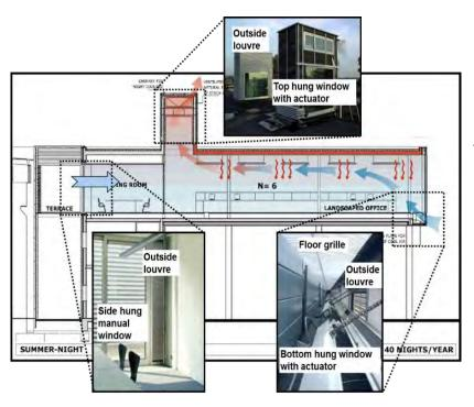
Fig. 9 NIGHT VENTILATION PRINCIPLE
