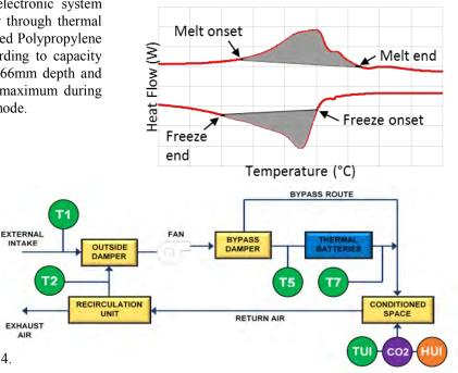
Fig. 6 COOL-PHASE PRINCIPLE
