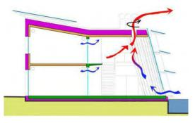
Fig. 8 VENTILATIVE COOLING PRINCIPLE, SOURCE: Architekturbüro Reinberg ZTGmbH
