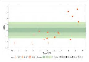
Fig. 24 SCATTERPLOT OF RELATIONSHIP BETWEEN MTSV AND OPERATIVE TEMPERATURE RAMP FROM THE START TO THE FINISH OF A TEST.
