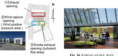
Fig. 15 RF SITE PLAN
